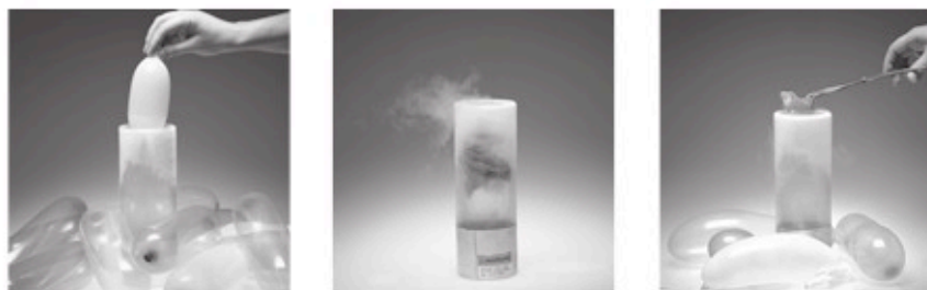
Globos llenos de aire son puestos en nitrógeno líquido.
